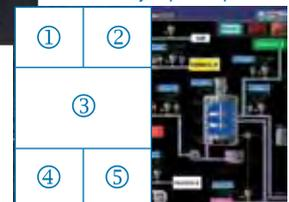
Con las barras de título de ventana enmascaradas, las ventanas se ajustan en segmentos de pantalla como se muestra en el ejemplo, mejorando en gran medida la flexibilidad en el diseño de pantalla.
