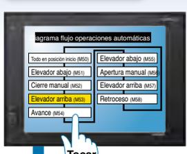
La operación se detiene a causa de razones desconocidas en un punto desconocido – la causa del problema se puede encontrar rápidamente rastreando las operaciones en la GOT.
