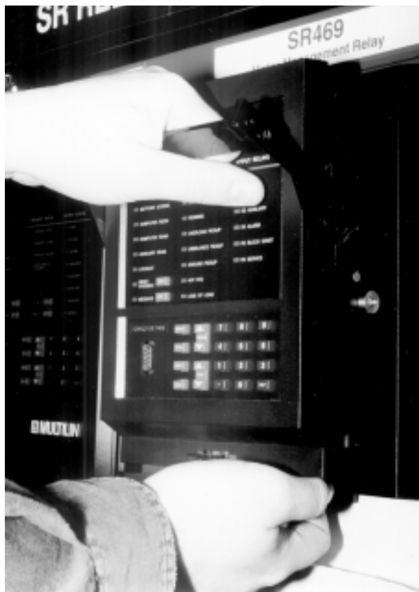
Figura 2-10 DESLICE LA UNIDAD FUERA DEL ESTUCHE
