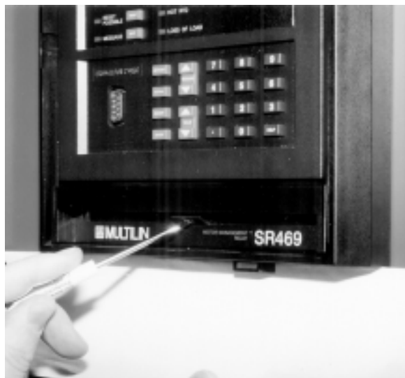
Figura 2-8 PRESIONE EL SEGURO PARA SOLTAR LA MANIJA
